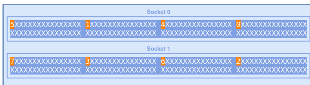
Abbildung 2.3.: Pinning-Verhalten auf JUSUF für die Reihenfolge der NUMA-Domains
